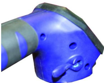
Rys. 1: pionowa pozycja dźwigni - blokada transportu aktywna
