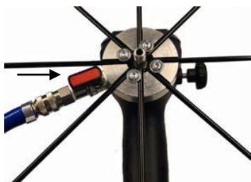
Rys. 14: Otwarty zawór odcinający
