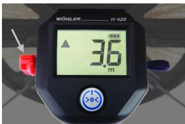
Rys. 10: Dźwignia do ustawiania hamulca
