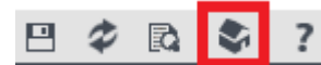
Rysunek 5 Przycisk uruchamiania TERMOCADIA oraz przełączania się i wymiany danych pomiędzy ArCADia-TERMOCAD a TERMOCADIA
